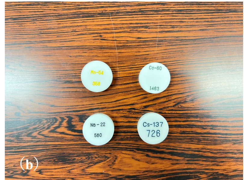
Fig.2 (a) 測定の様子 (b)使用した線源
