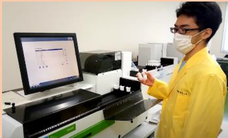
コンクリート中に移行した放射性核種の測定の様子
