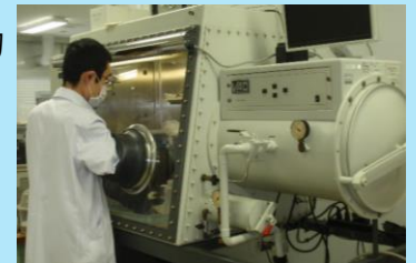
低酸素雰囲気下(地下深部模擬)の金属腐食実験の様子
